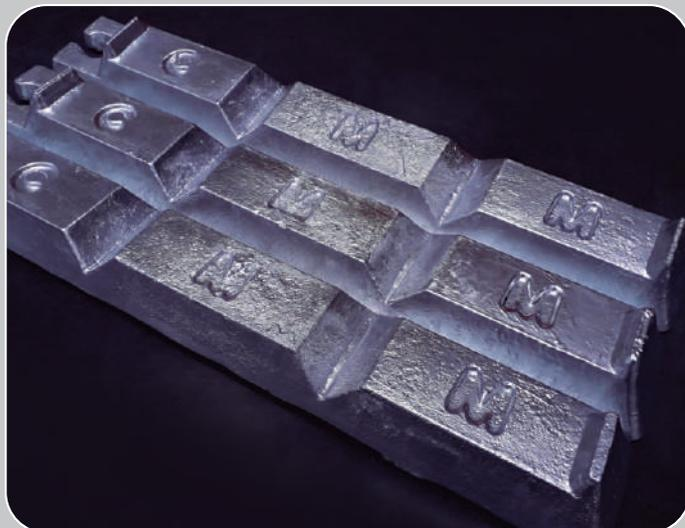
O alumínio participa com 4% e é de grande importância no processo de fundição por facilitar a vazão do material fundido. Na sequência temos o magnésio com 0,05% em média e o cobre com até 3% na composição da liga, sendo que ambos contribuem para maior resistência mecânica e dureza.
