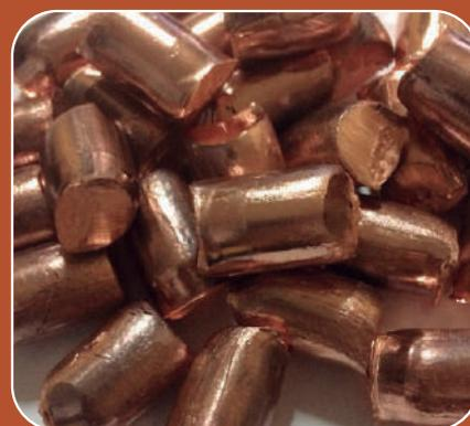
**IMPORTANTE:** Nunca utilizar o anodo de cobre eletrolítico em banhos de cobre ácido. Para banhos de cobre ácido usar o anodo de **cobre fosforoso**, também com 99,98% de cobre metal, mas com 0,04 a 0,07% de fósforo na liga, de extrema importância para o funcionamento perfeito da eletrólise. **É identificado por tinta azul.** Sem a presença do fósforo o anodo polariza e para de trabalhar. Um indicativo que o anodo fosforoso está operando normalmente é a presença de um filme escuro sobre ele.
